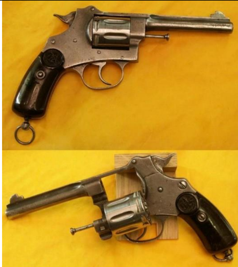
Револьвер Пипера «Баярд», конкурировавший с Наганом на российском оружейном конкурсе. Внизу — с выдвинутым для заряжания в бок барабаном.
